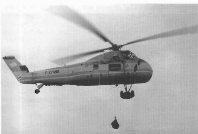
фото из отчёта ОКБ им. М.Л.Миля по испытаниям на S-58 гидролебёдки BL-1315 для подъёма на борт человека или грузов
