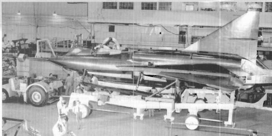
Первый XF2Y-1 в экспериментальном цехе фирмы Конвэр. Самолет установлен на тележке и готовится к окончательной окраске – остекление закрыто бумагой, а датчики на штанге ПВД закрыты коробкой. Гидролыжи – в буксировочном положении
